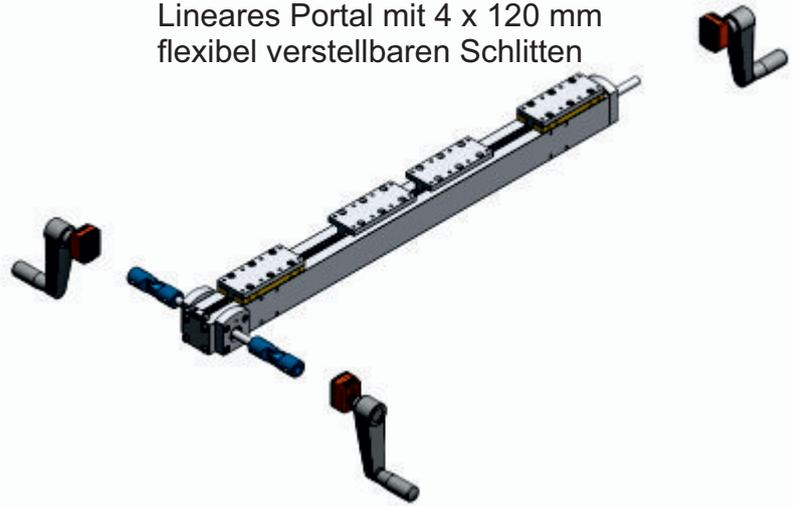
Lineares Portal mit 4 x 2 synchron mit einem Handrad verstellbaren Schlitten
