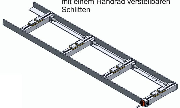
horizontales Portal mit 1 Antrieb und 4 x 120 mm Schlitten mit paralleler Verstellung
